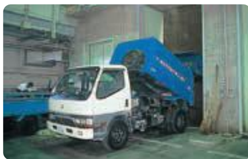
ごみをごみピットへ投入するところ
